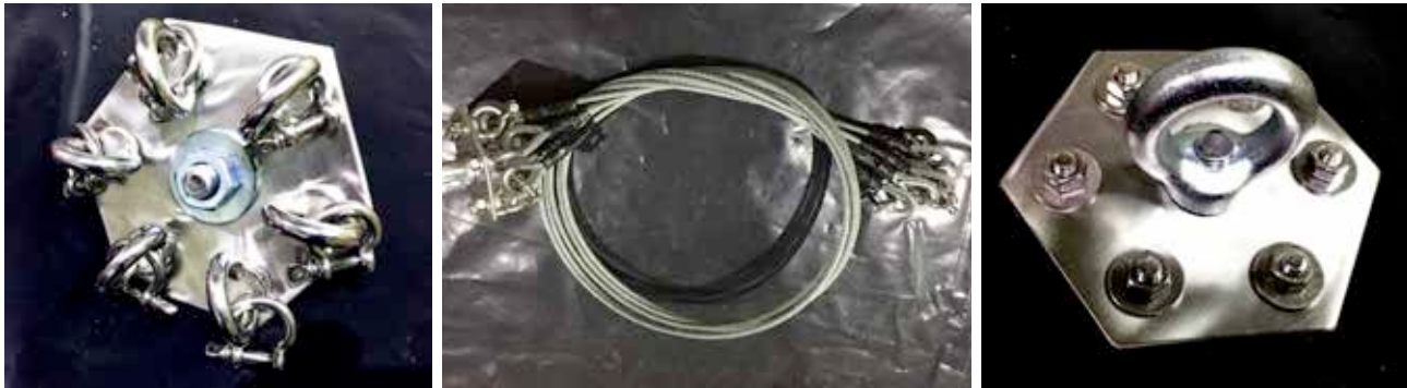
punto de suspensión de 6 vías y cables de suspensión (AD)
