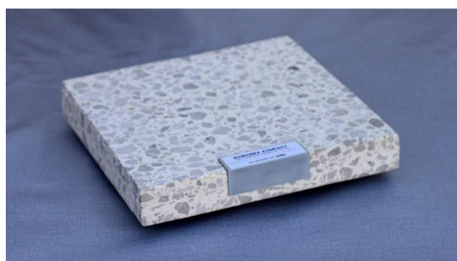
bloque de 28,2 x 28 x 3,9 cm 3,9 Kg – densidad 1,31 g/cm 3 acabado en pátina nácar
