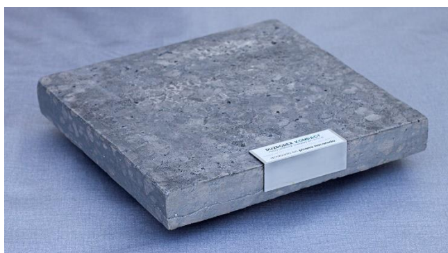
bloque de 28,7 x 28,3 x 3,3cm 3,4 Kg – densidad 1,3 g/cm 3 acabado en pizarra nacarada
